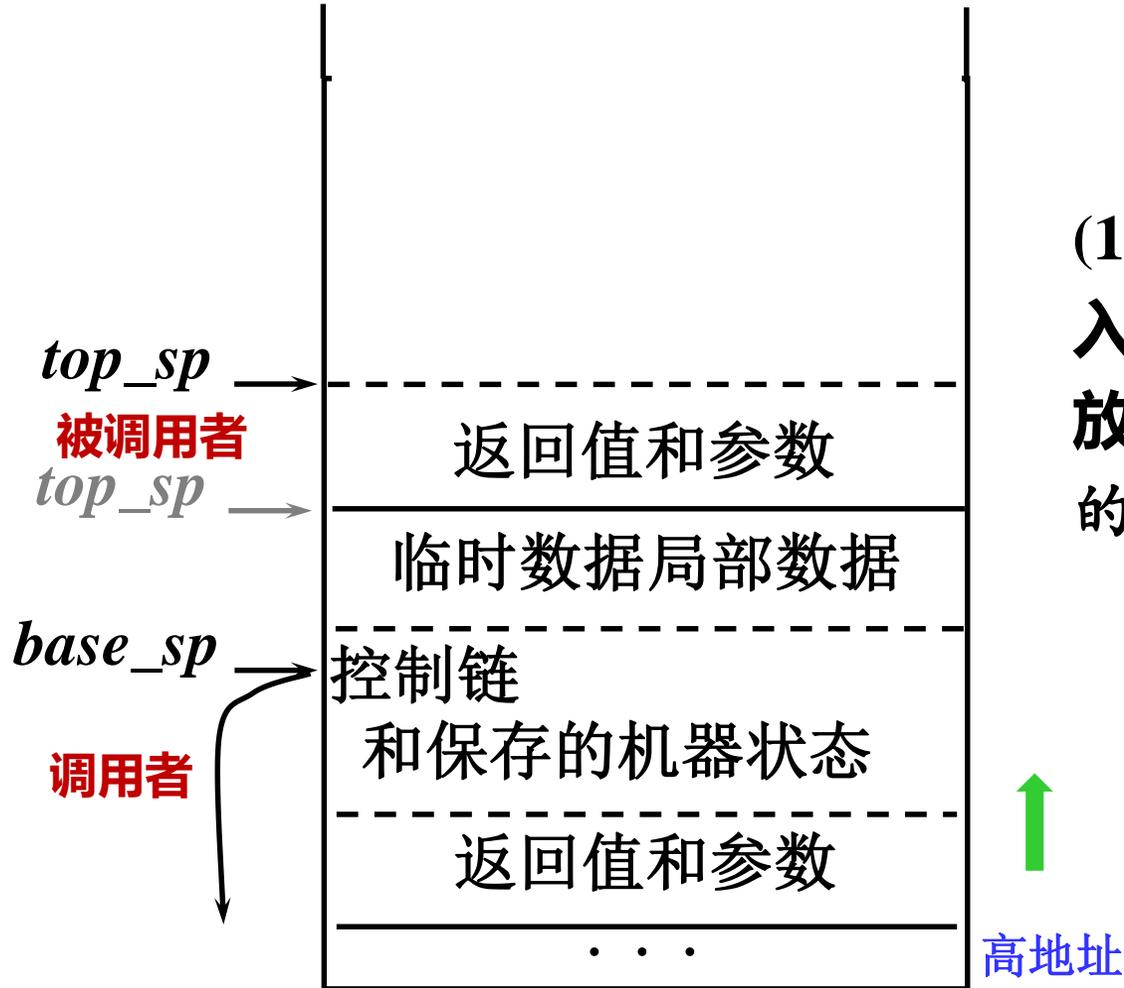
(1) p计算实参，依次放入栈顶，并在栈顶留出放返回值的空间。 $top\_sp$ 的值在此过程中被改变
