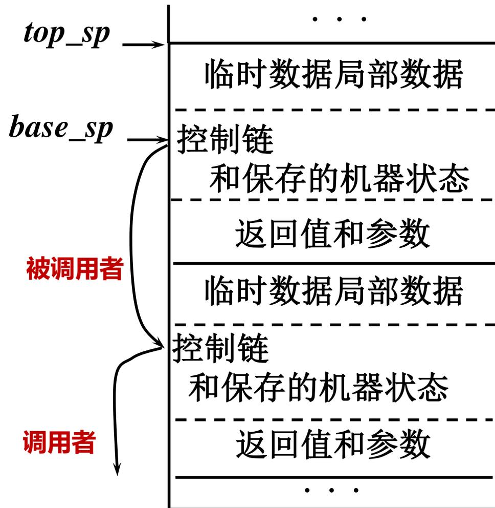
(4) q根据局部数据域和临时数据域的大小增加 $top\_sp$ 的值（分配局部变量和临时数据的空间），初始化它的局部数据，并开始执行过程体
